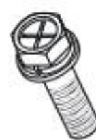
Vis de mise à la terre (M5*10)
